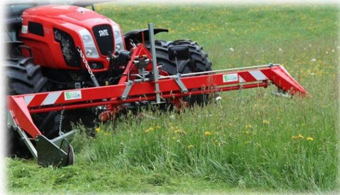
Wenig Leistungsbedarf, wenig Gewicht und grosse Flächenleistung. Dies sind die Eigenschaften unseres Mähwerks. Die Anfahrsicherung hängt zuverlässig aus, so dass das Mähwerk bei einer Kollision mit einem Gegenstand keinen Schaden nimmt.
